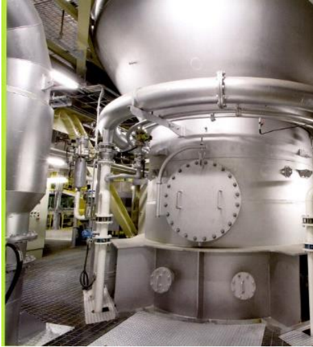
溶融炉：炉内は 1700～1800 度で溶融
